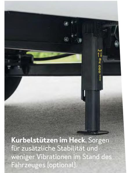
**Kurbelstützen im Heck.** Sorgen für zusätzliche Stabilität und weniger Vibrationen im Stand des Fahrzeuges (optional).
