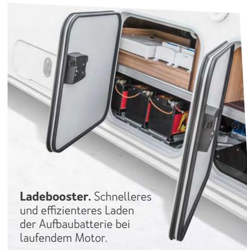
**Ladebooster.** Schnelleres und effizienteres Laden der Aufbauatterie bei laufendem Motor.
