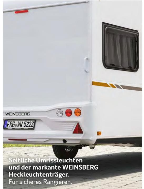
**Seitliche Umrissleuchten und der markante WEINSBERG Heckleuchtenträger.** Für sicheres Rangieren.
